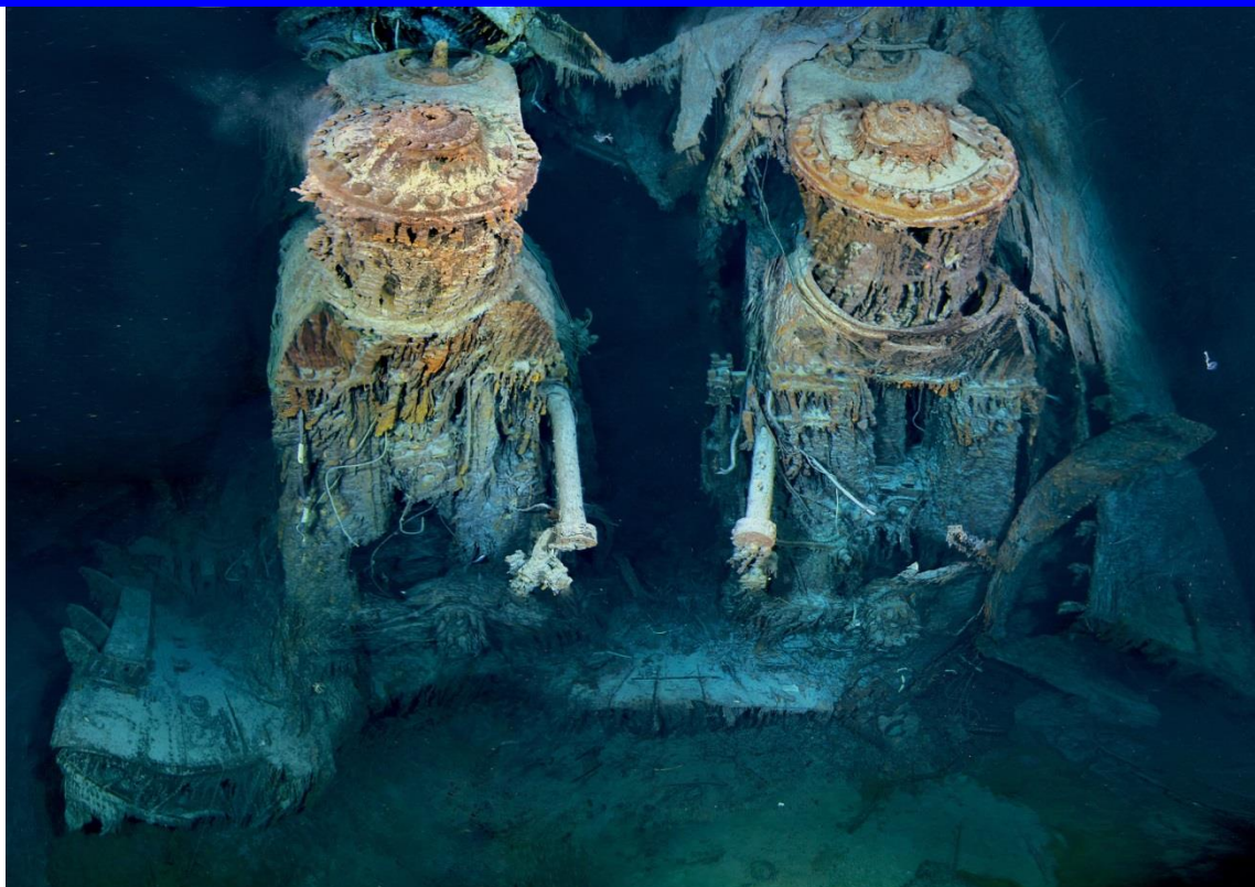
Rester av två stycken trippel huvudångmaskiner
