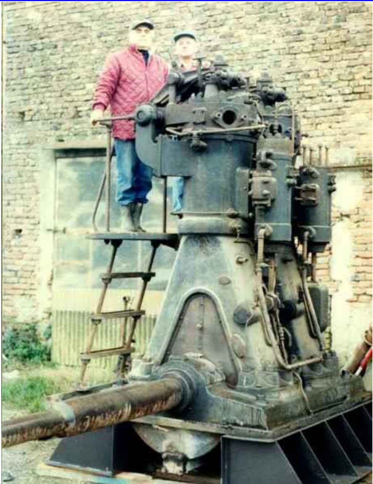
Här har vi en stor 2-cylindrig 4-takts dieselmotor av det tyska fabrikatet SCHLÜTER 2D-30. Enligt ägaren är det en 30 hk motor som varit avsedd för generatordrift.
