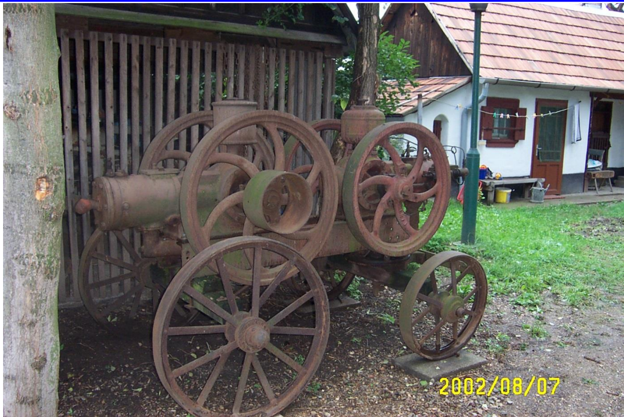
Ett udda par. Två motorer monterade på samma vagn. Till vänster en Mietz & Weiss kopia och till höger en orenoverad Bolindermotor av äldre modell.
