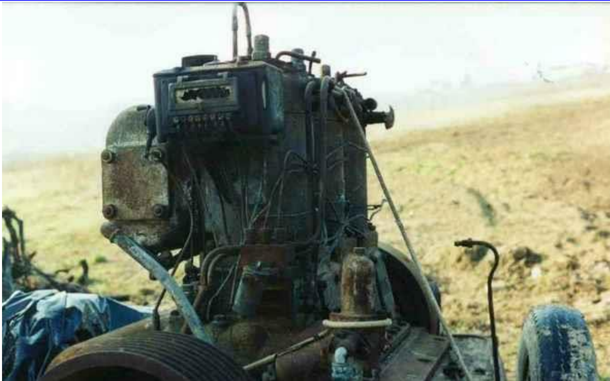
En 3-cylindrig tidig DEUTZ 2-takts diesel med möjlighet att värma pluggarna på toppen före start. Typen är en OMD på 122 hk. Lämpligt renoveringsobjekt.
