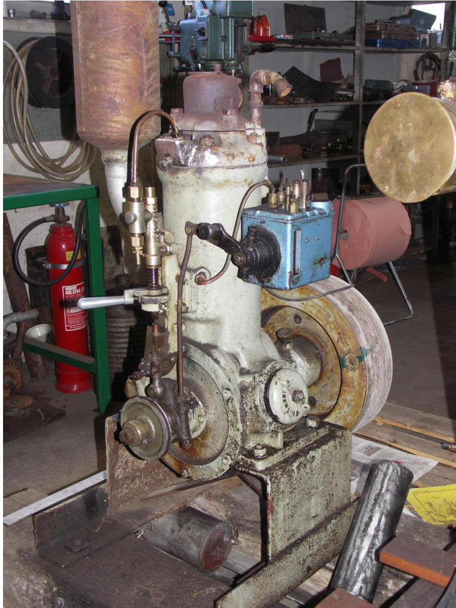
En mycket gammal JÄ tändkulemotor nu för restaurering på Målilla Mekaniska Verkstad www.tandkulan.com
