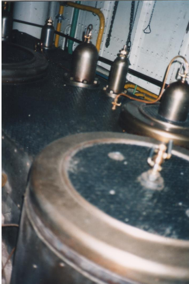
Toppen på högtryckscylindern på den aktra ångmaskinen på 2800 hk
