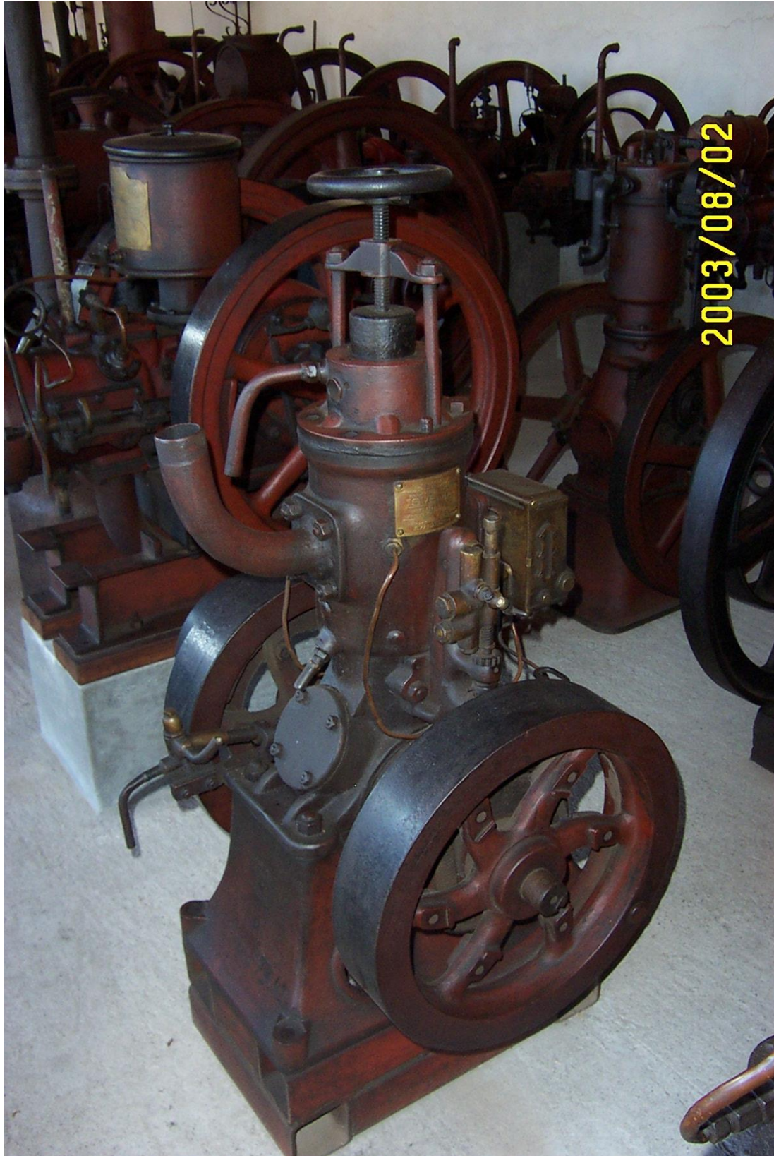
Kanske den hittills äldsta Bergsundmotorn som jag fann utomlands hos en samlare. Motorn har tillverkningsnummer 165 är på 5 hk vid 600 v/m. Motorn är troligen från 1912 då man införde denna typ av lubrikator och centrifugalregulator av 1911-års modell Se föregående bild
