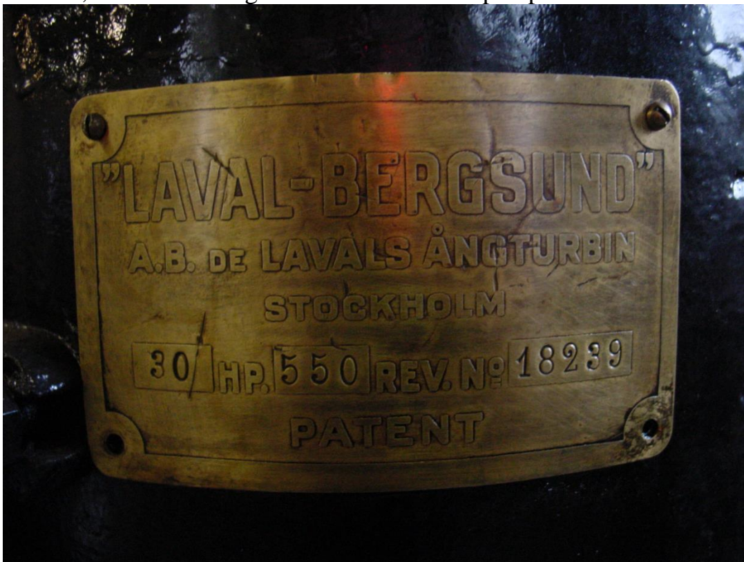
Laval-Bergsund 2-cylindrig marinmotor nr 18239 tillverkad i Stockholm på 30 hk vid 550 v/min
