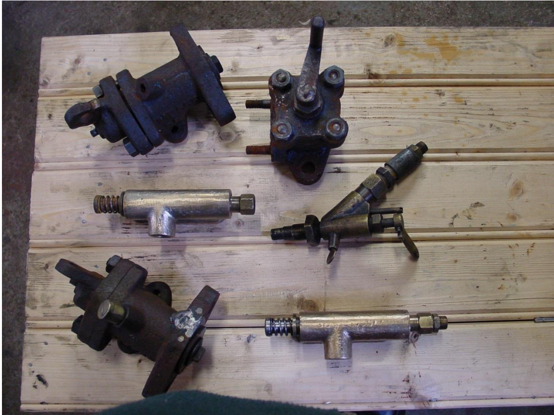
Startventil, och omkastningsventiler samt bränslepumpar och bränsleventilen.
