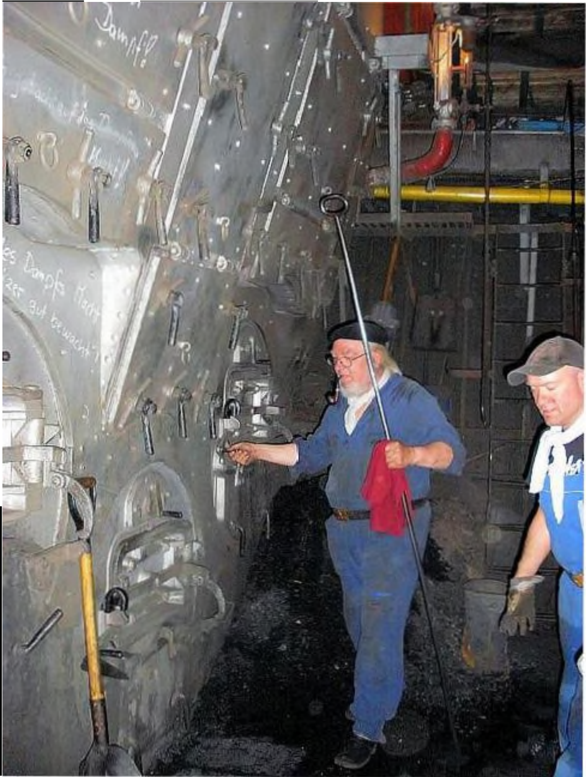
Eldaren har slagat ut fyrarna med slaggspettet och dragit ut askan från asklåda på durken.
