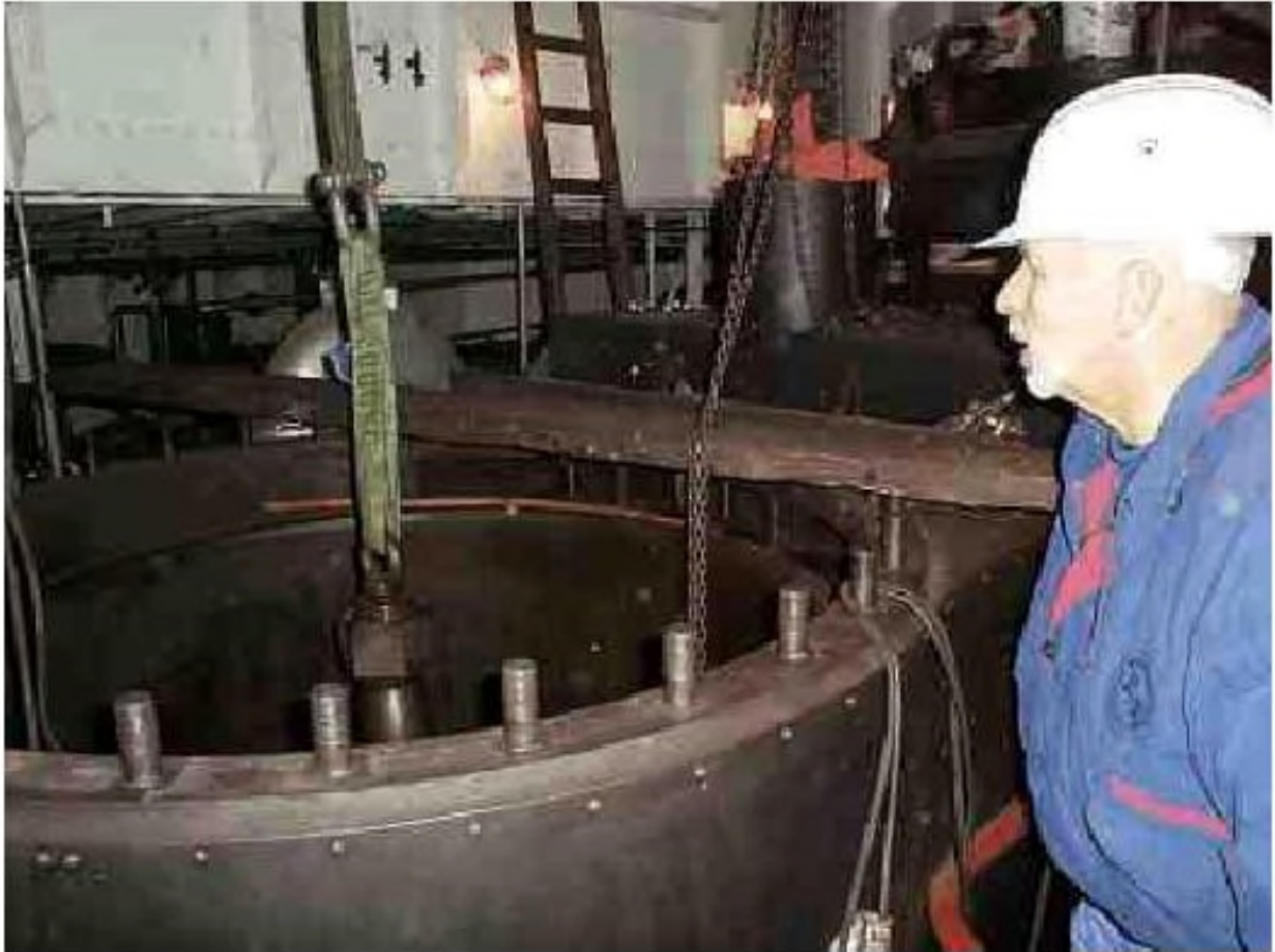
Kolvhalning på LT-cylindern
