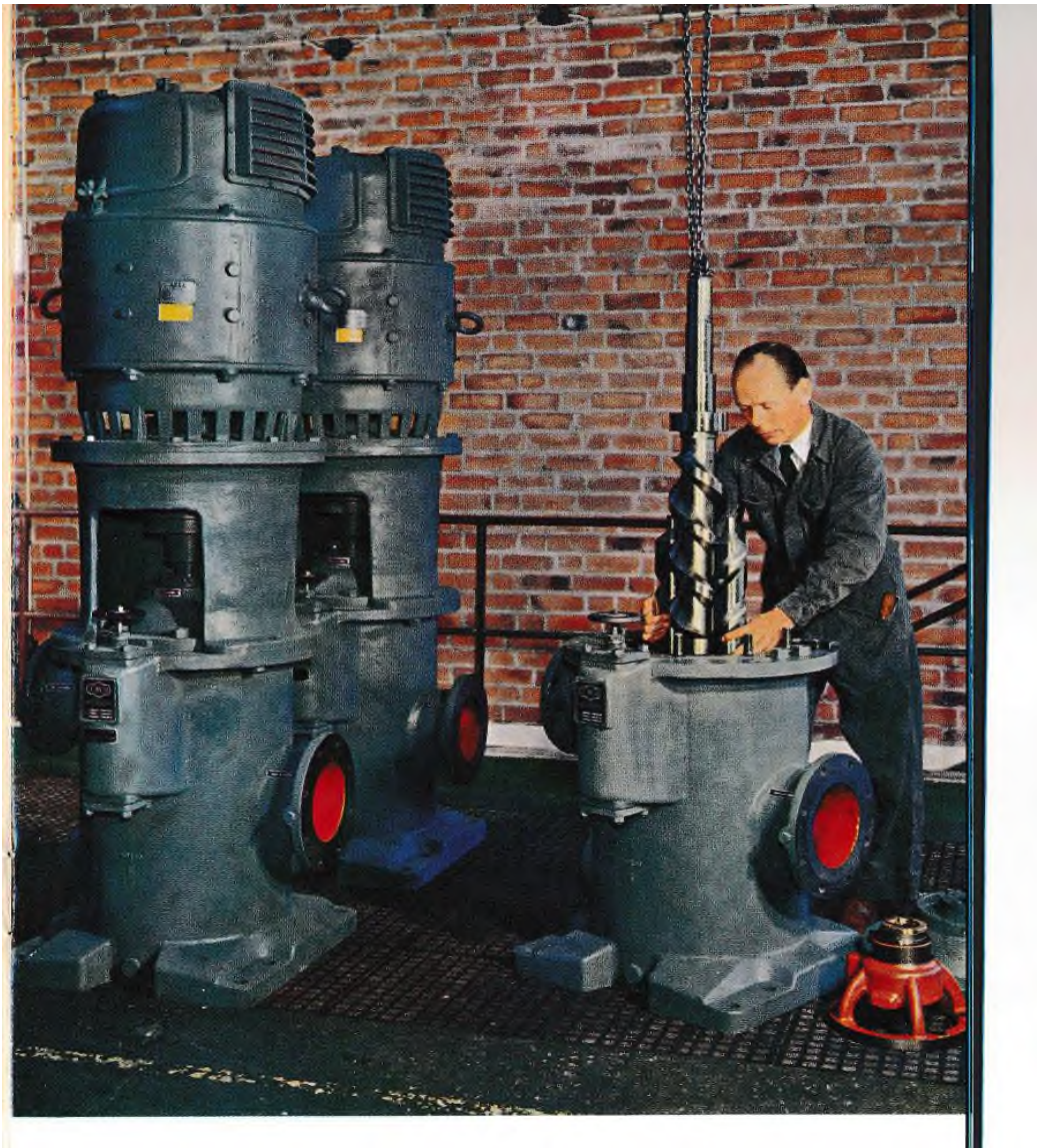
Montering av en skruvsats i en vertikal IMO-pump. Till vänster två färdiga för leverans.
