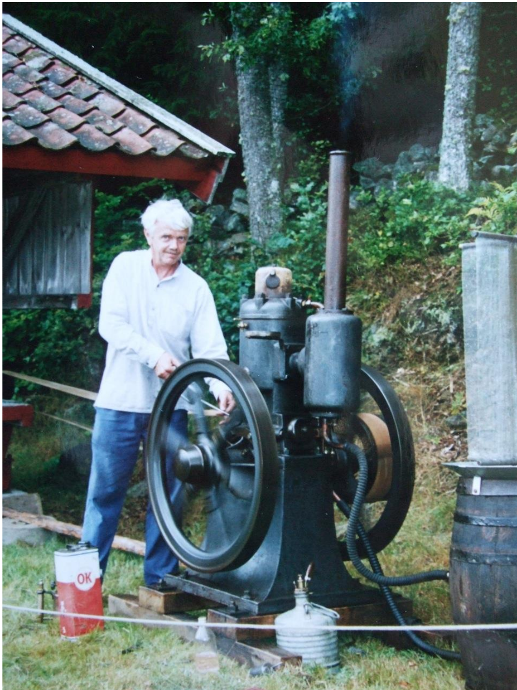
Thomas Davidssons Skandiamotor typ 14, 4-6 hk från 1909. Modifierad 1910 med ny regulator och större vevlager.
