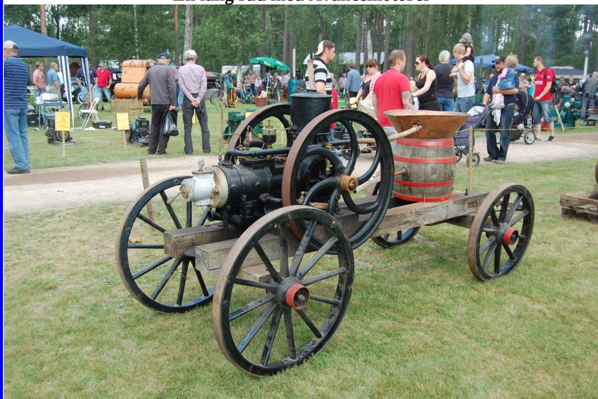
Min egen 2 hk Avancemotor nr 467 från början av förra seklet. Har en gång drivit en trovpress/kvarn på en torvmosse i mina hemtrakter i Skåne Motorn har ingen kylvattenpump utan självcirkulerar sk. termosifonskylning
