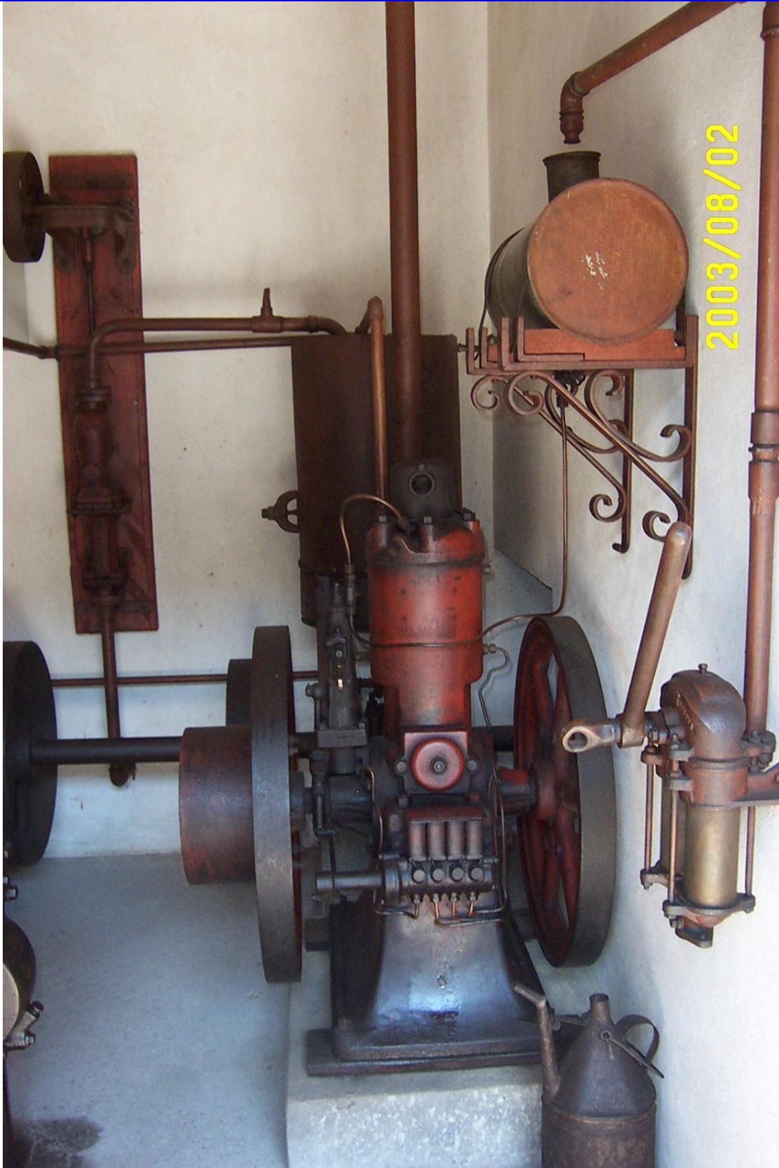
En gammal 7 hk Skandiamotor från 1912.
