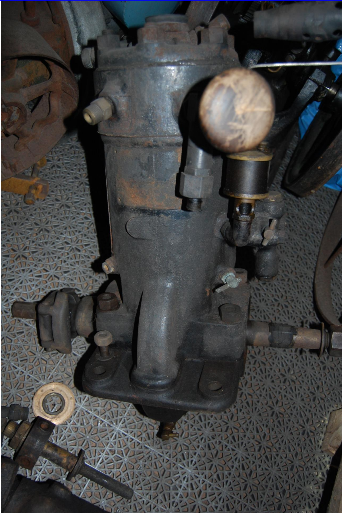
En tidig Skandia typ 21 med droppoljesmörjning.
