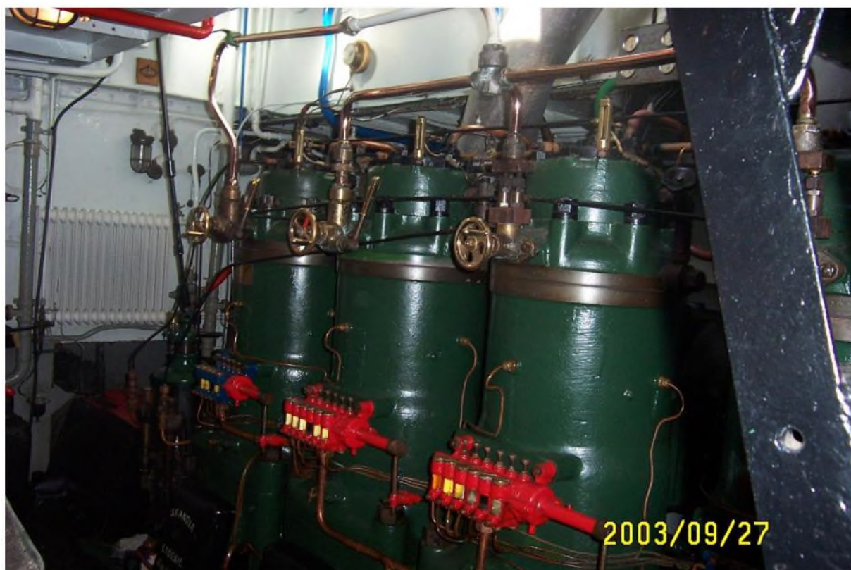
Huvudmaskinen på Harry. Motorn är Skandia Typ 480 på 300 Hk. Cylinderdiametern är 320 mm och slaglängden är på 370 mm. Denna motortyp tillverkades under perioden 1947-1950.
