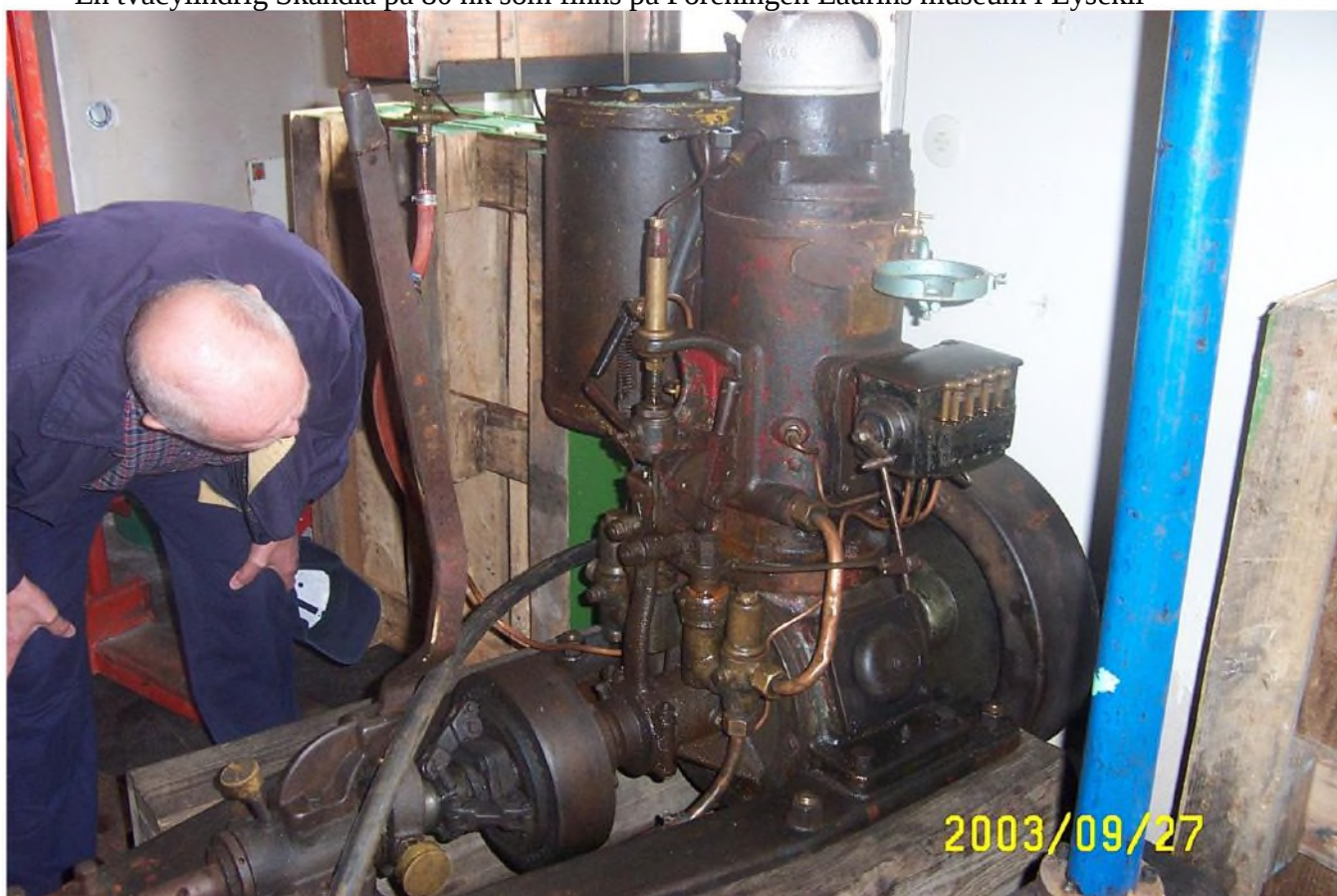
En äldre frislagsreglerad marin tändkulemotor som även finns i Lysekil
