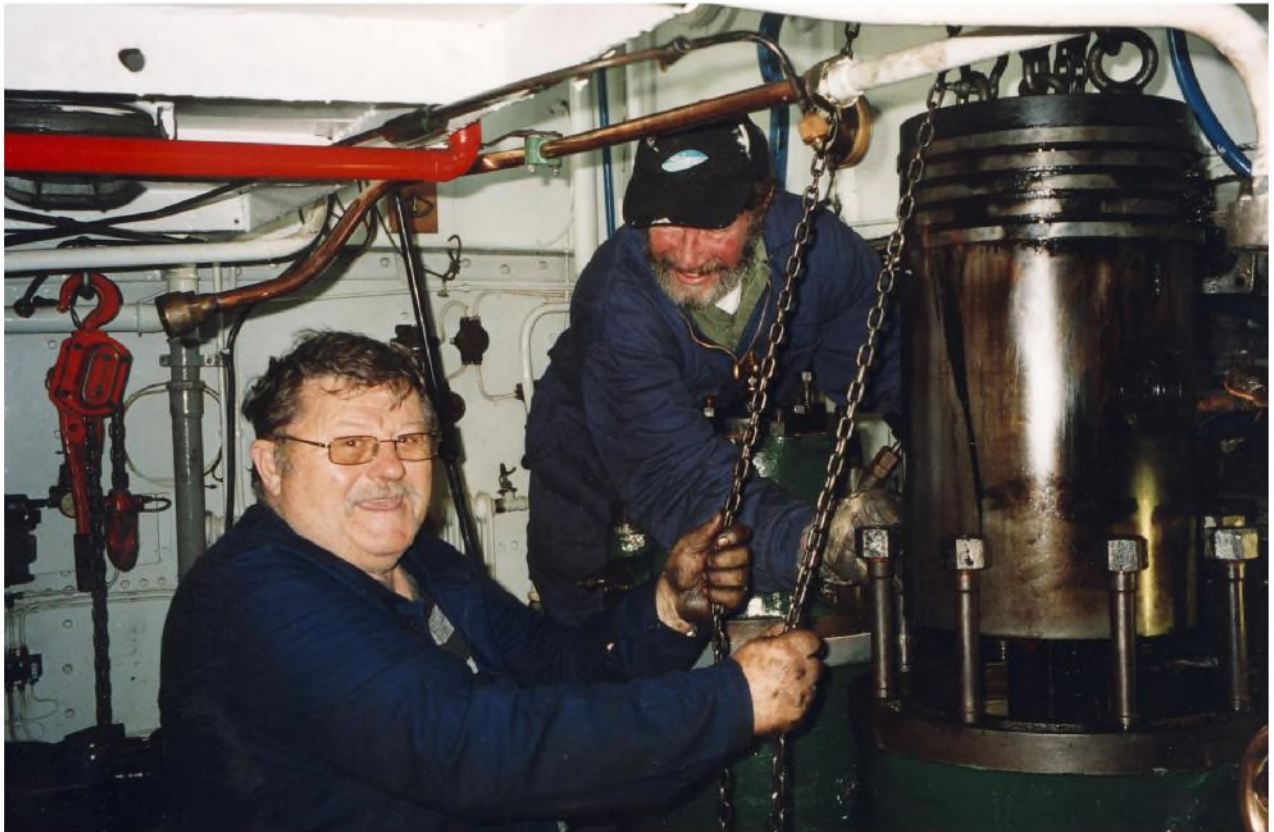
En kolvhalning på Harrys motor. Lennart Lindberg till vänster är i sitt verkliga jag. Han har seglat hela sitt liv på de sju haven och jobbat med många olika motorer.
