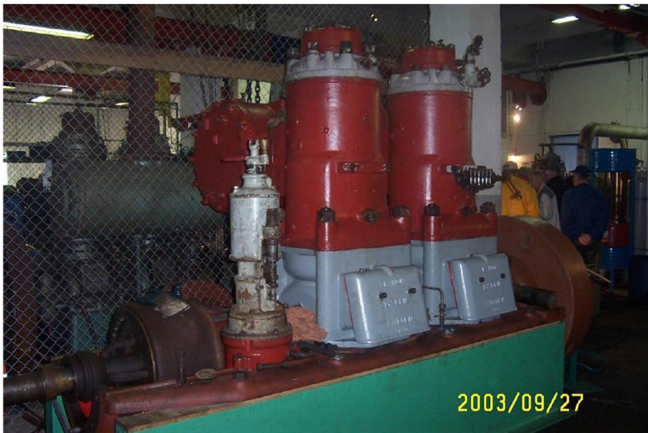
En tvåcylindrig Skandia på 80 hk som finns på Föreningen Laurins museum i Lysekil
