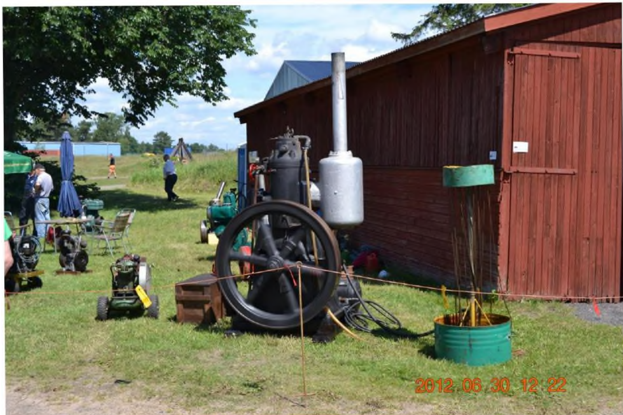
Detta är Kurt Månsson stationära Skandiamotor 81S, på 30 Hk, försedd med luftstart
