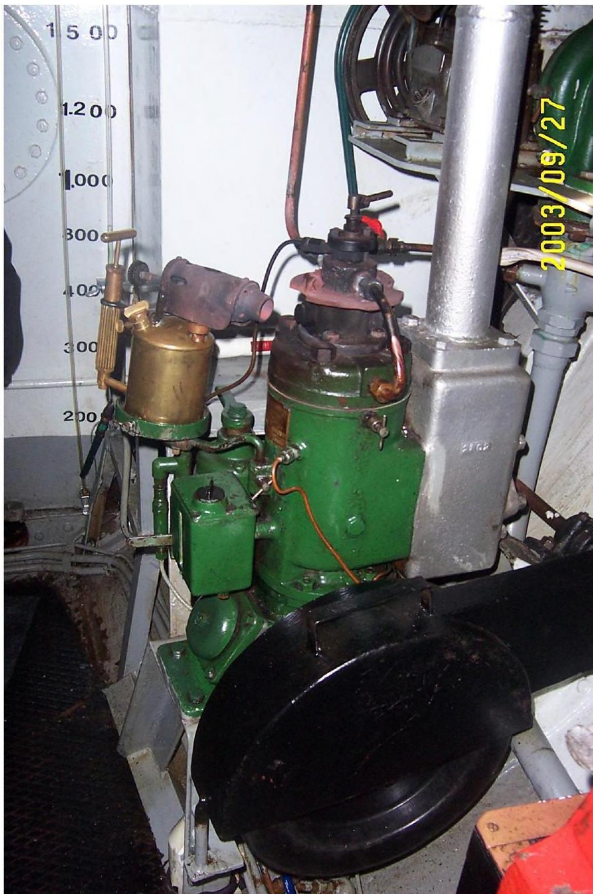
Hjälpmotorn är en mindre Seffle tändkulemotor med toppinsprutning och vridbar bränsleventil.
