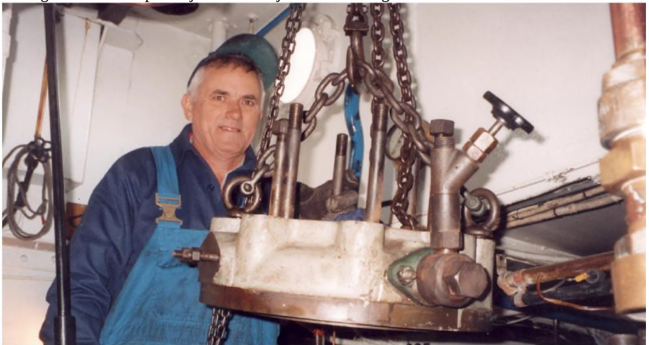
Här har man lyft en av maskinens topplock
