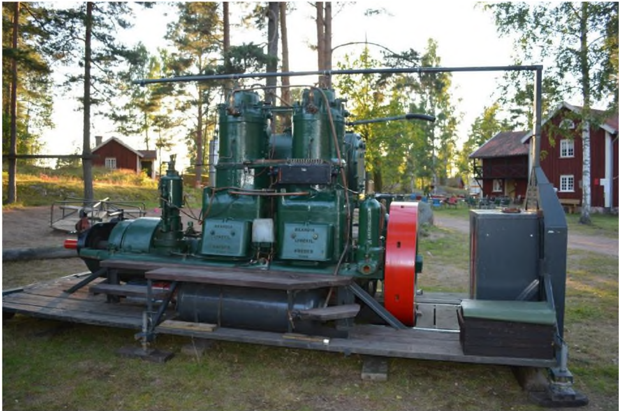
2-cylindrig marin Skandiamotor av senare datum
