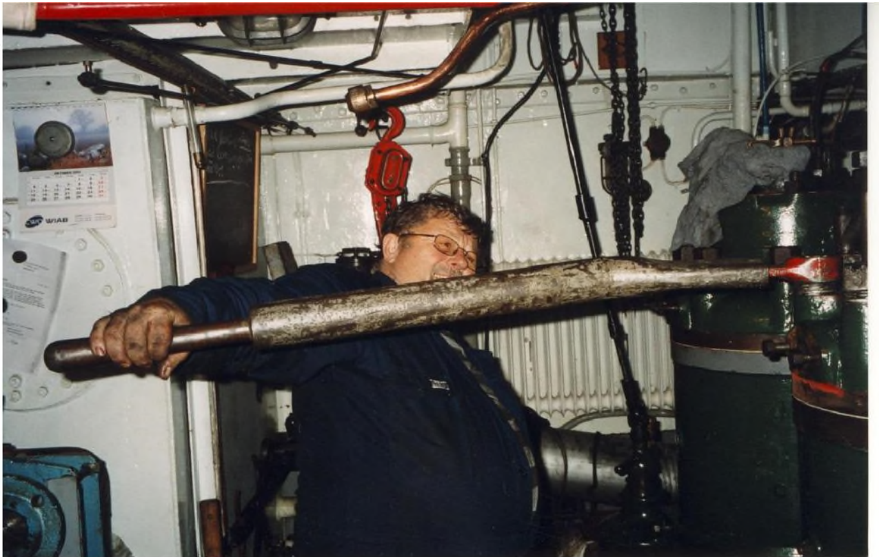
Lennart Lindberg drar topplocks-bultarna efter en kolvhalning
