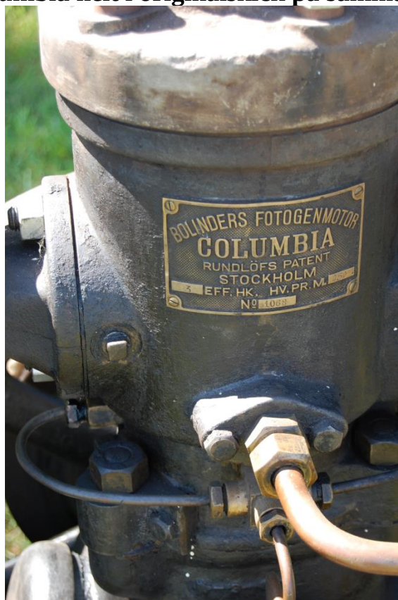
Bolinder Fotogenmotor på 3 hk vid 250 v/min med nummer 1068. en motor av tidig tillverkning
