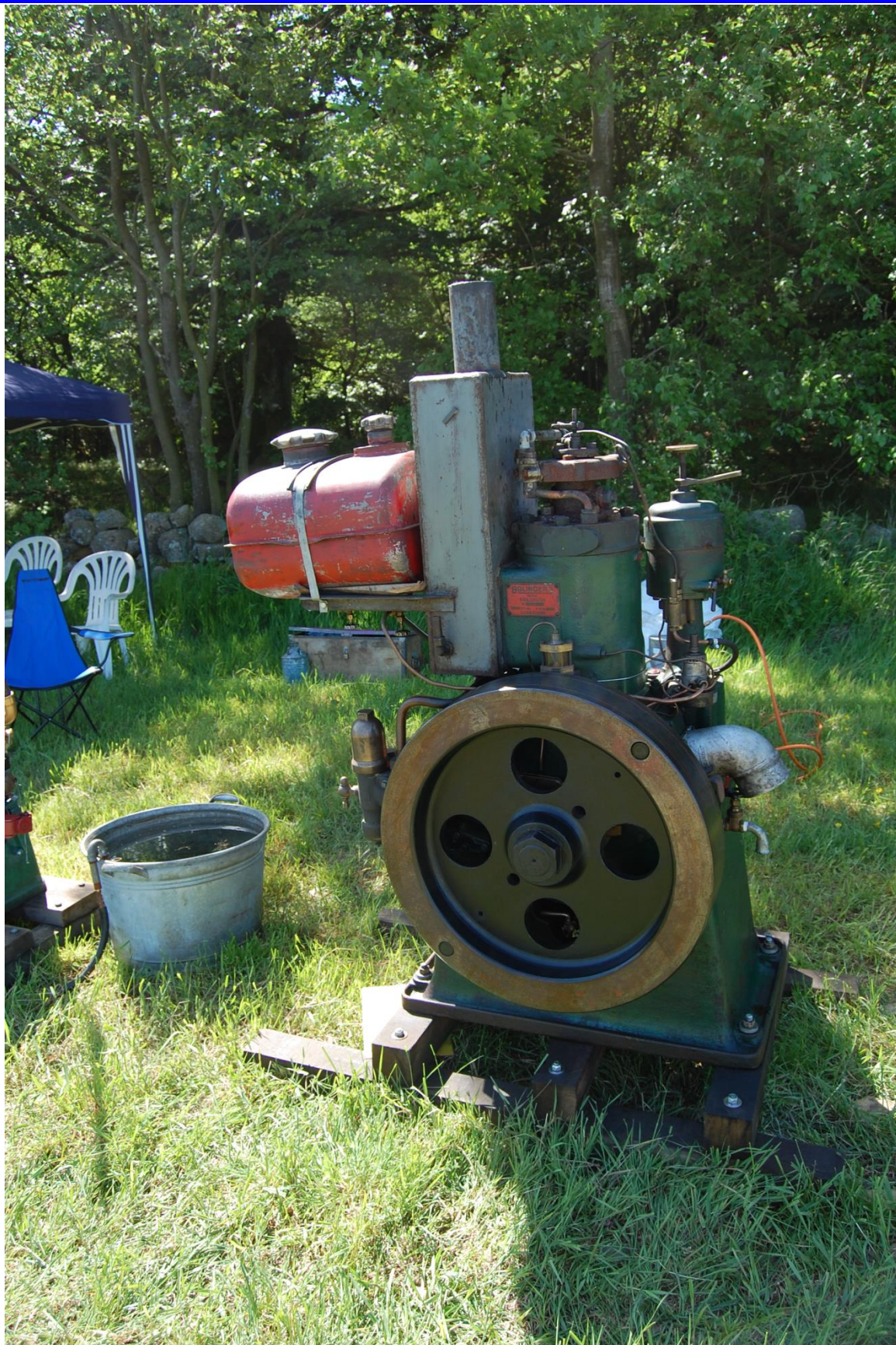
En fin Bolinder av senare modell på Vitebroutställningen 2008. 25 hk vid 800 v/min med tillverkningsnummer 29515??
