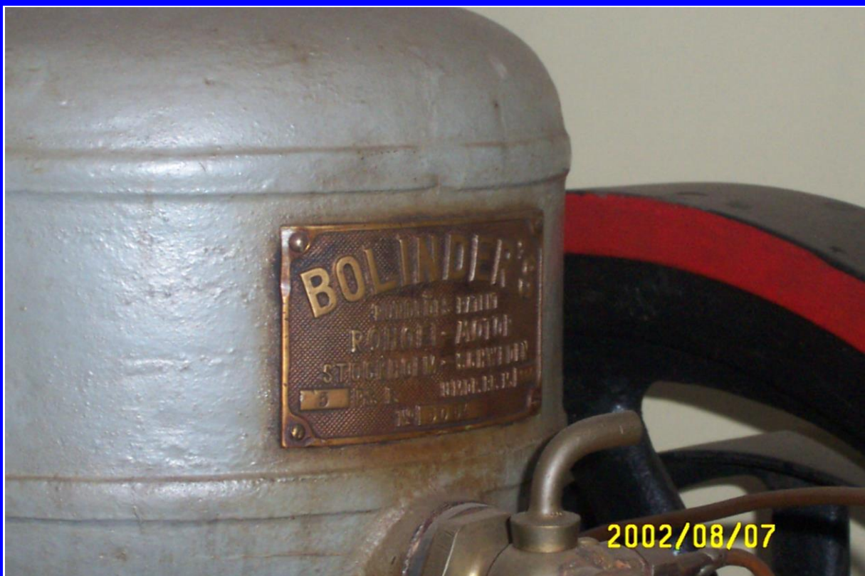
Motorn är på 5 hk med tillverkningsnumret 5004
