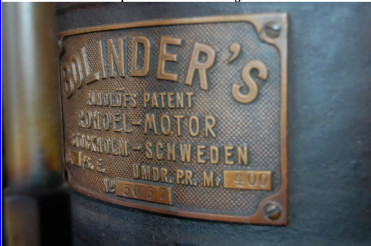
Här en fint renoverad Bolinder Rundlöfs patent på 6,5 hk vid 400 varv/min med tillverkningsnummer 5057 Motorn finns på nästa sida
