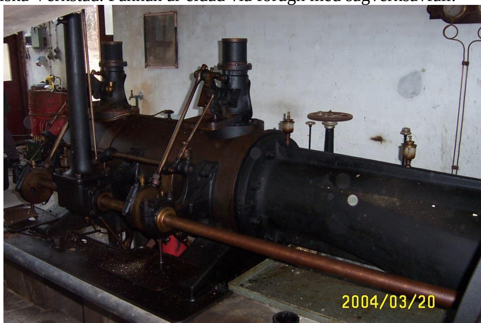
Ångpannan har levererat kraft till en Bolinder ventilångmaskin på 150 hk som drivit ett större ramsågverk. Maskinen är i mycket gott skick och ägaren har för avsikt att starta anläggning som ett industriminne. Har drivit en generator i ett större ramsågverk och tidigare varit monterat i ett större mejeri i Mellansverige. Maskinen är försedd med s.k. stålingskondensor som innebär att kondensatet blandas och kyls med råvatten från en sjö. /NES
