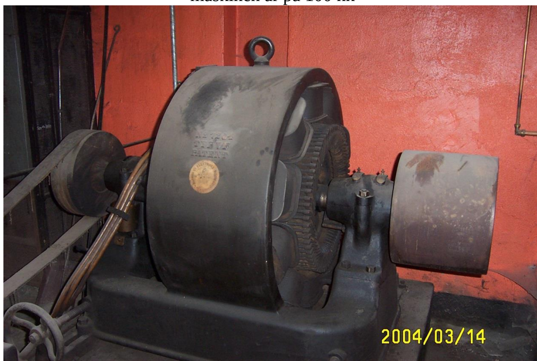
Den har drivit en mycket gammal ASEA-växelströmgenerator, som för ovanlighetens skull levererade strömmen från rotorlindningen istället för statorn.
