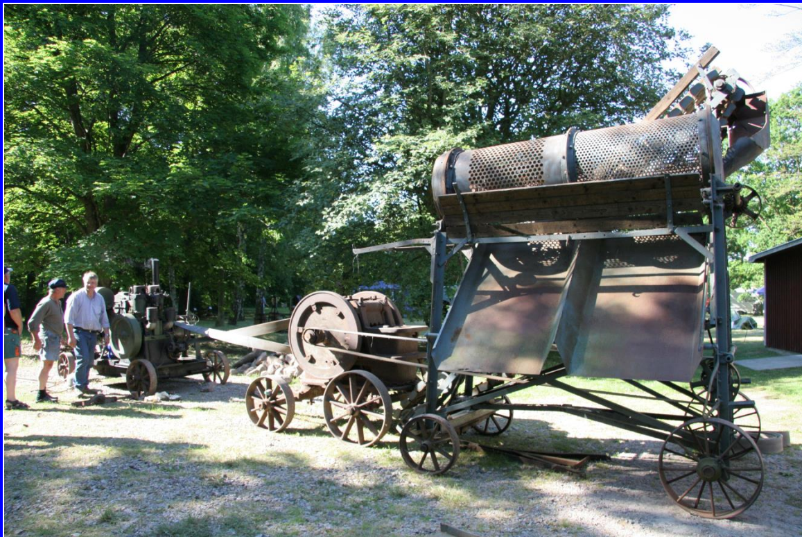
Ronnie Sjöholms 2-cylindriga Bolinder W7 på 50 hk. Motorn är en original byggd stationär motor med slutet kylsystem och remdriven kylarfläkt. Den brukar alltid visas upp i Degeberga där den drar en SVEDALA stenkross med skoelevator och sorteringsverk. Ronny har själv tillverkat skoporna till elevatoren då de var helt upprostade.
