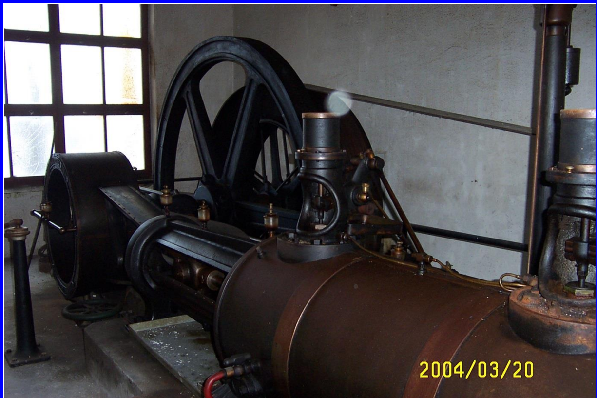
En Bolinder ventillångmaskin i mycket gott skick på 150 hk
