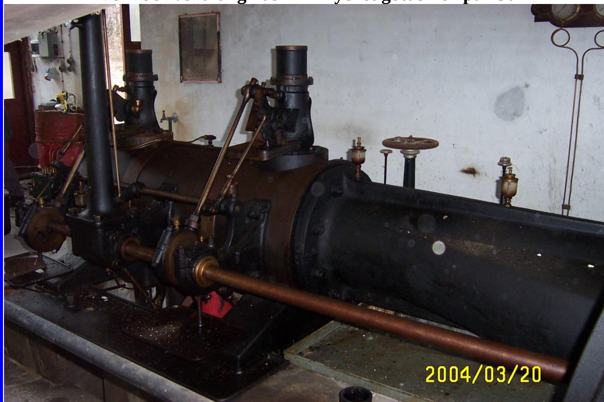
En Bolinder ventillångmaskin i mycket gott skick på 150 hk
