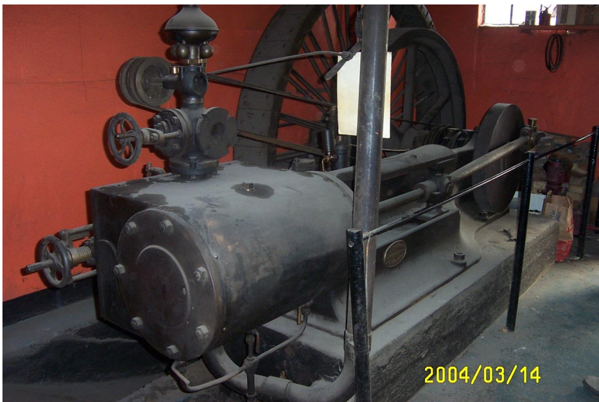
En mycket ovanlig ångmaskin från slutet av 1800-talet tillverkad vid Ljunggrens mekaniska verkstad i Kristianstad. Den troligen största man tillverkat då maskinen är på 100 hk
