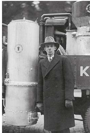
Här står broder Axel Swedlund med ett gengasaggregat kopplat till en lastbil.
