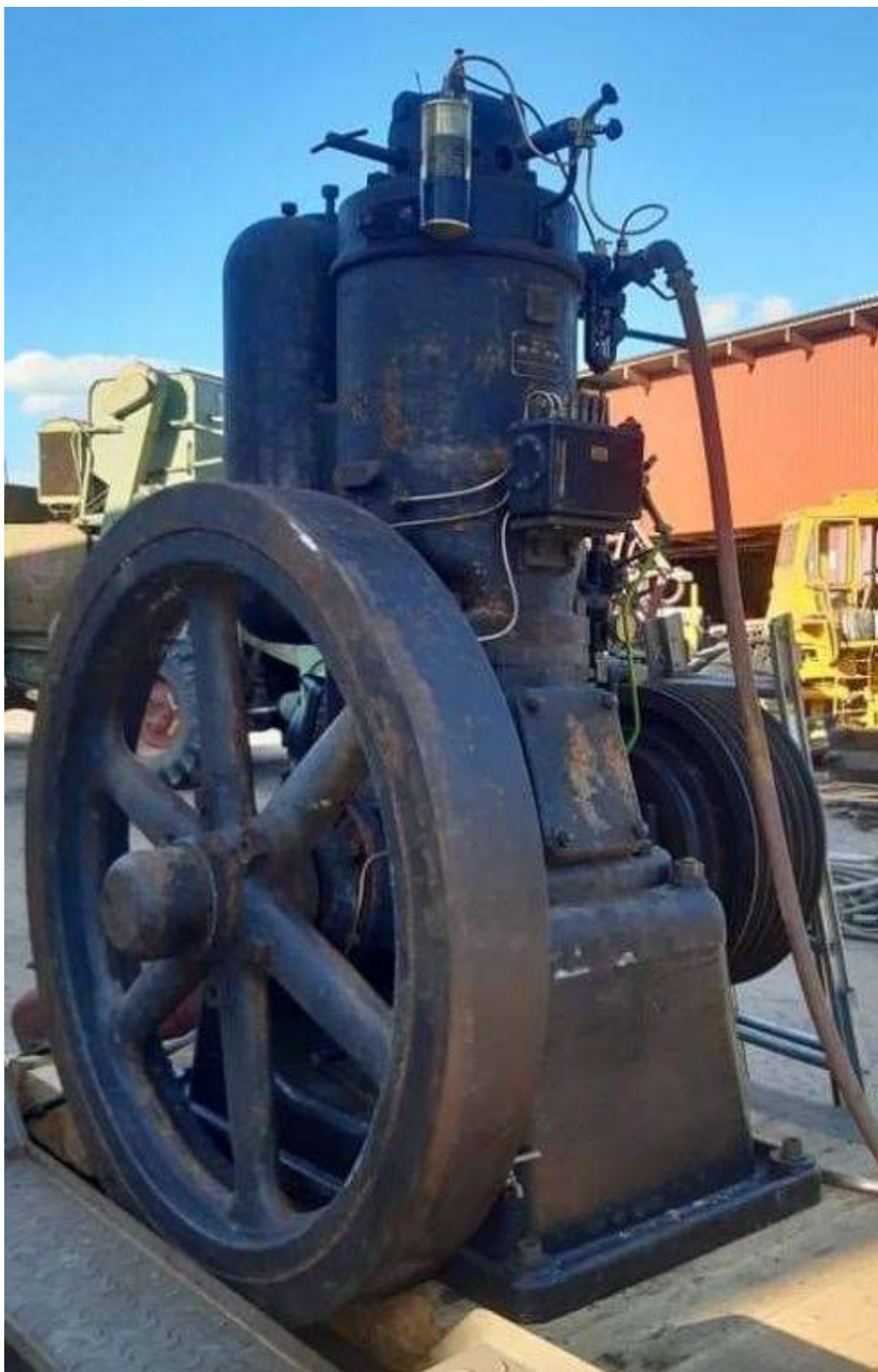
Jan Quick äger denna Pythagoras motormodell 50 troligen på motsvarande hästkrafter. Kan startas både med luft och glödpatron.
